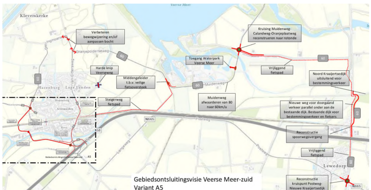
Figuur 2.4 Variant A5 op hoofdlijnen. Grotere versie in bijlage beschikbaar (einde rapport)
